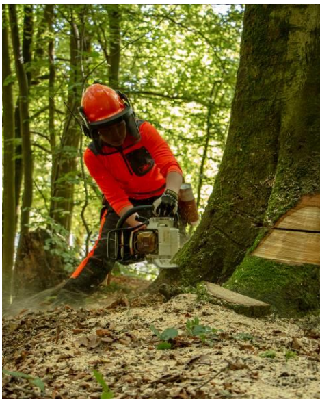
Abb.8: Die Fällung wird i.d.R.* mit dem negativ ausgeführten Fällschnitt beendet.
